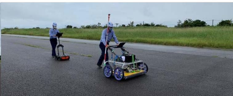
3Dレーダ（グランドカップル型）計測及びパルスレーダ計測の様子
