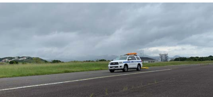
RSVによる3Dレーダ（エアカップル型）計測の様子
